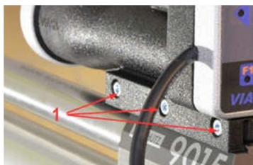
Paso 1: Apriete ligeramente los tornillos
