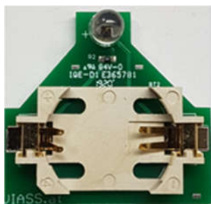
IR-LED Paper für 3V CR2025 Batterie
