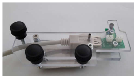
IR-LED Multi (optional) für USB Versorgung
